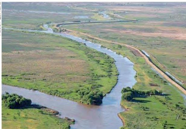
**Figura 10.-** Vista de un terraplén ilegal construido a orilla del río Baradero (Delta del Paraná) para proteger de manera permanente áreas de cultivo previamente inexistentes.
