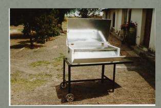
La cocción se realiza en un horno solar, de esta manera hacen uso de energía alternativa.
