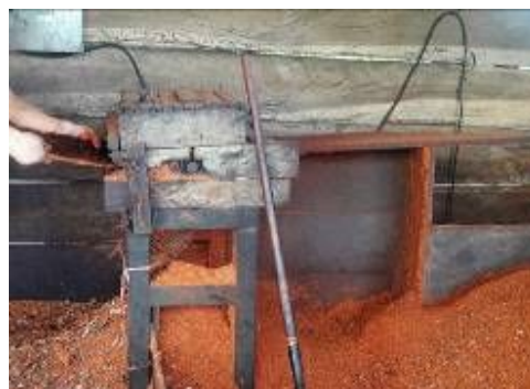
Proceso de molido de la cascara del mangle rojo, para uso en curtiembre, 2016.
