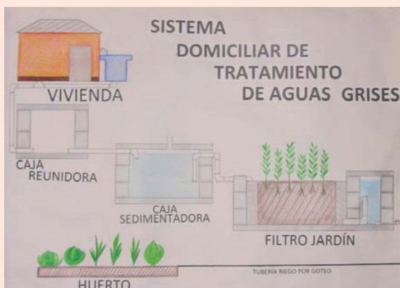
Figura 1. Diagrama de los componentes de un filtro verde y recorrido del agua para su tratamiento hasta el huerto familiar.
