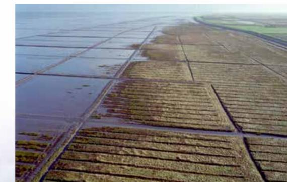
La **ingeniería híbrida** combina estas estructuras permeables con técnicas de ingeniería para romper olas y capturar sedimento, tales como el dragado el cual aumenta la cantidad de sedimentos suspendidos en el agua.
