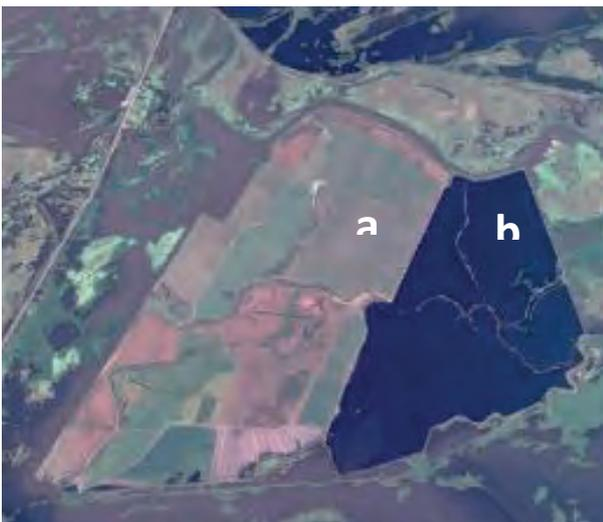
Figura 3.- Respuestas de endicamientos durante la creciente del 2016. a. endicamientos con forestación joven y en perfecto estado; b. área endicada completamente anegada. Imagen CNES Airbus Pleiades NEO del 27-3-2016.
