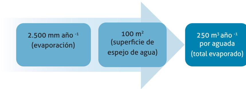
**Figura 3.-** Cálculo del potencial volumen de agua evaporado por año por aguada.
