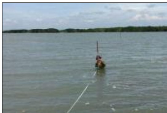
Imagen N°8.6. Marcado del nivel del mar. Fuente: Permeables Structures, 2020 © Joost Fluitsma – JAM Visual Thinking.
