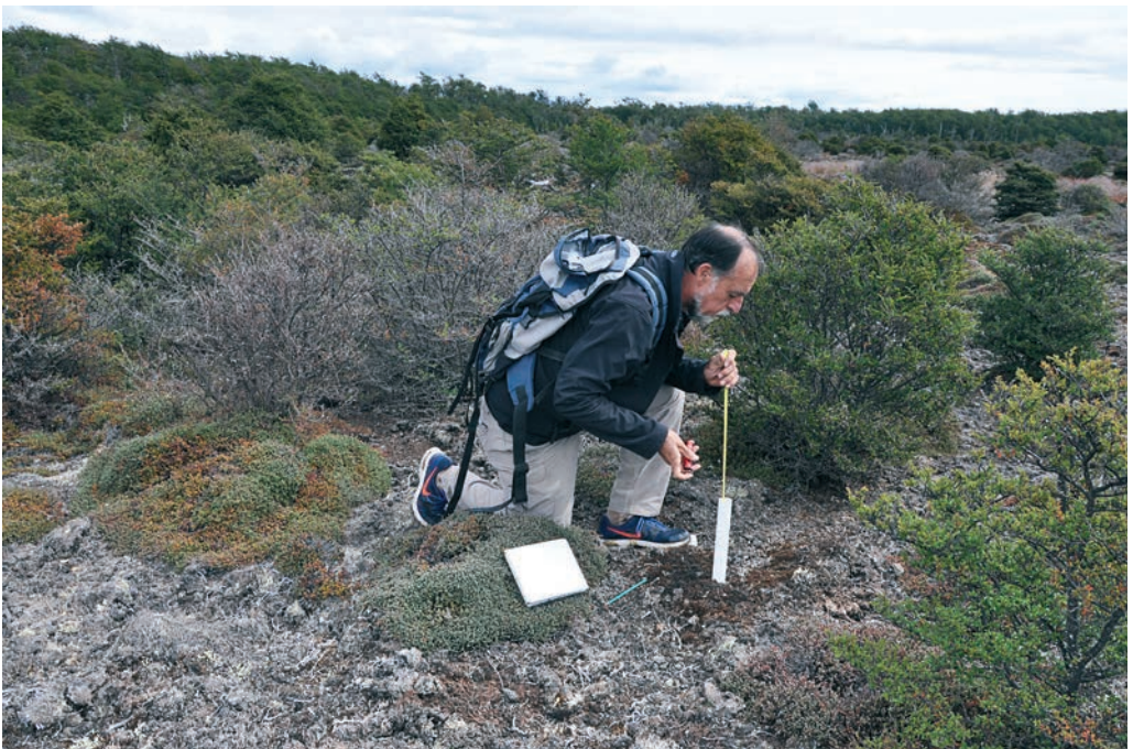
Figura 14.- Monitoreo del nivel de agua en la turbera usando tubos perforados (freatímetros).
