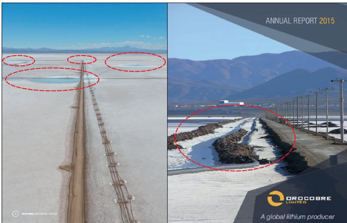
Figura 5.- Precarias obras de infraestructura caminera. A la izquierda se observan endicamientos producidos por un camino y a la derecha una intervención para que la inundación no afecte el camino. Fuente: modificado de Sales de Jujuy (2015).
