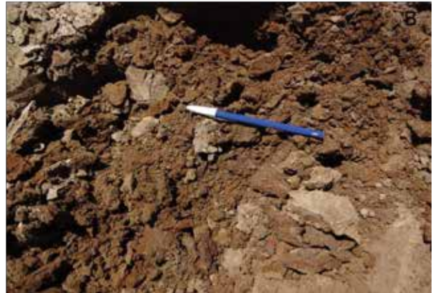
Figura 2. Fotos del cauce en brazo Oeste del río Cincel en el sitio RC-BW-12. A)-borde entre el cauce y la llanura de inundación donde se tomó la muestra. B) detalle de los sedimentos con precipitados de óxidos de hierro donde co-precipitan metales.
